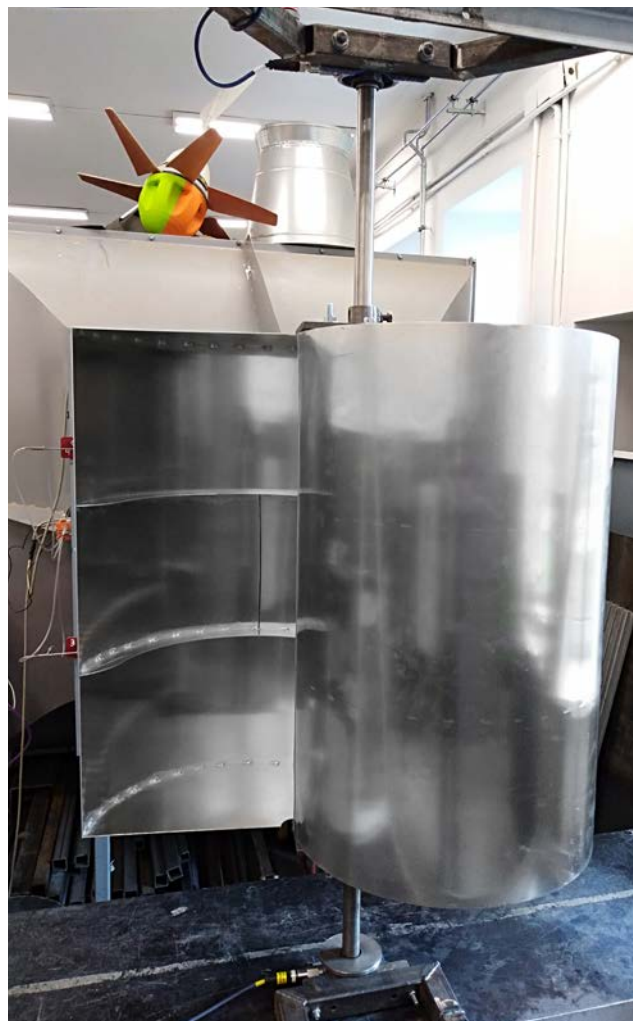
▼ Badanie konstrukcji przydomowej turbiny wiatrowej w tunelu aerodynamicznym
