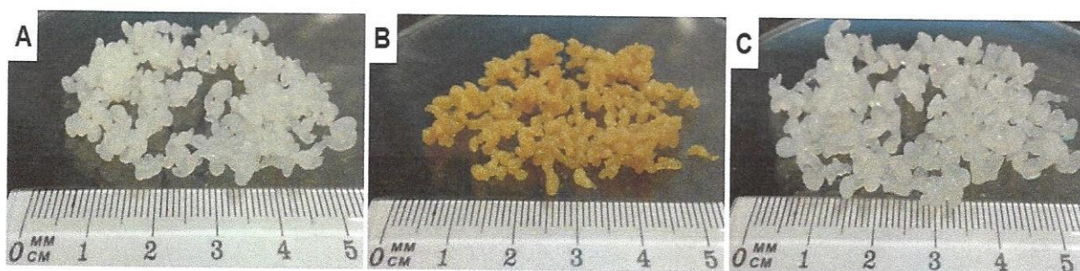
Rys. 1. A) Hydrożelowe granulki chitozanowe niesieciowane (CHs); B) Hydrożelowe granulki chitozanowe sieciowane z aldehydem glutarowym (CHs-GLA); C) Hydrożelowe granulki chitozanowe sieciowane z epichlorohydryną (CHs-ECH)
