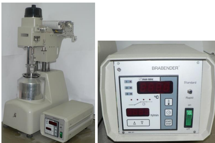
Fot. 5. Amylograf Brabendera z elektroniczną kontrolą temperatury
