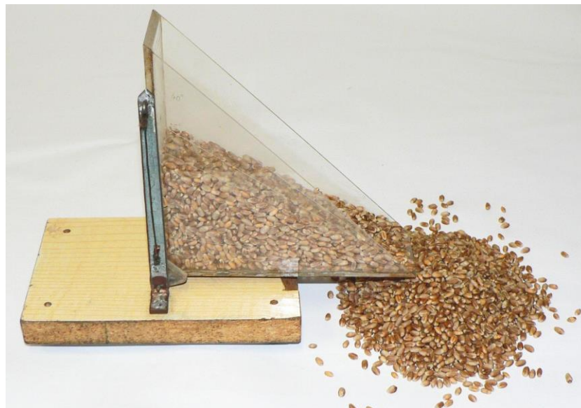
Fot. 5b. Przyrząd do oznaczania kąta zsypania wg Zielenkowa ( położenie pomiarowe )
