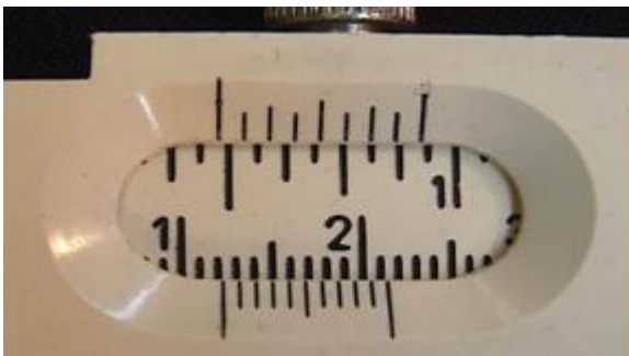
Rysunek 9. Przykład odczytu z suwmiarki. Zmierzona długość obiektu jest równa 1,23 cm (dolna skala).
