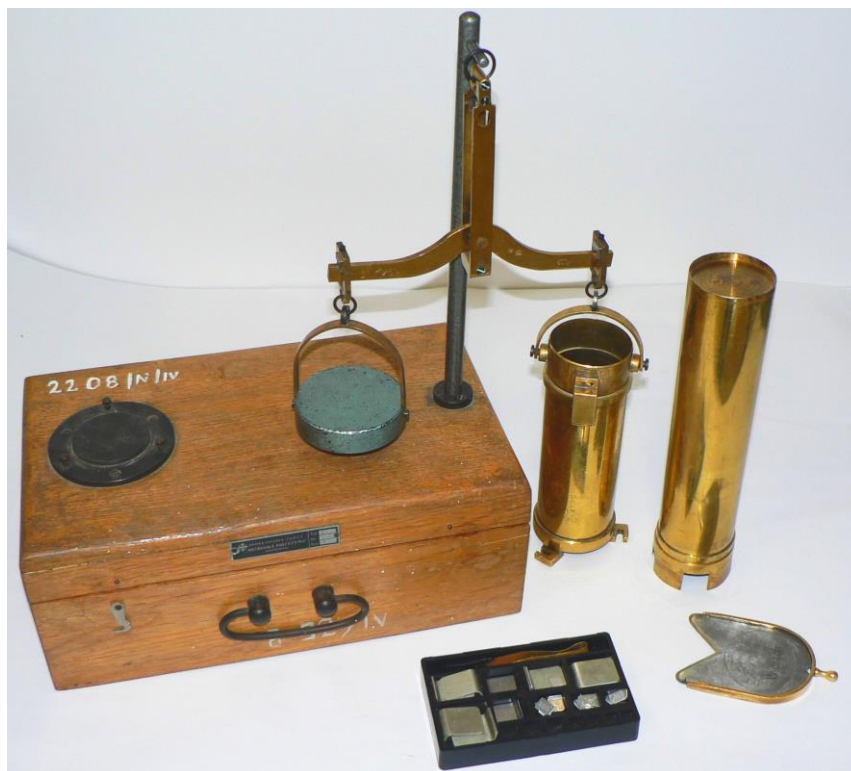
Fot. 3. Waga holenderska po złożeniu do oznaczania gęstości w stanie zsypanym
