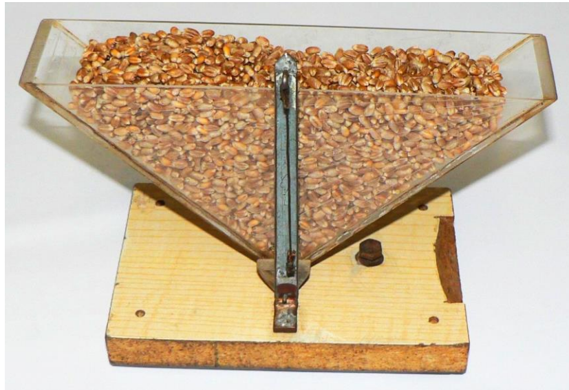
Fot. 5a. Przyrząd do oznaczania kąta zsypania wg Zielenkowa ( położenie początkowe )
