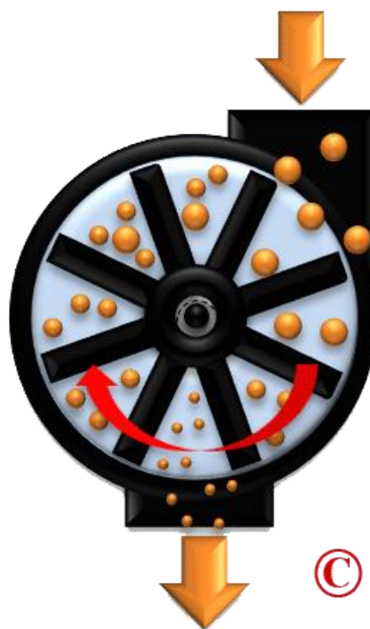
Rys. 3. Zasada działania młownika młotkowego
