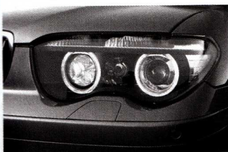
Rys. 5.26 Diody świecące LED w światłach postojowych i do jazdy w dzień
