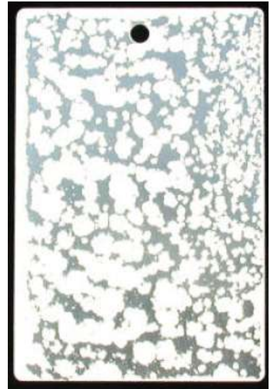
Fot. Osady „białej rdzy” na powierzchni cynku
