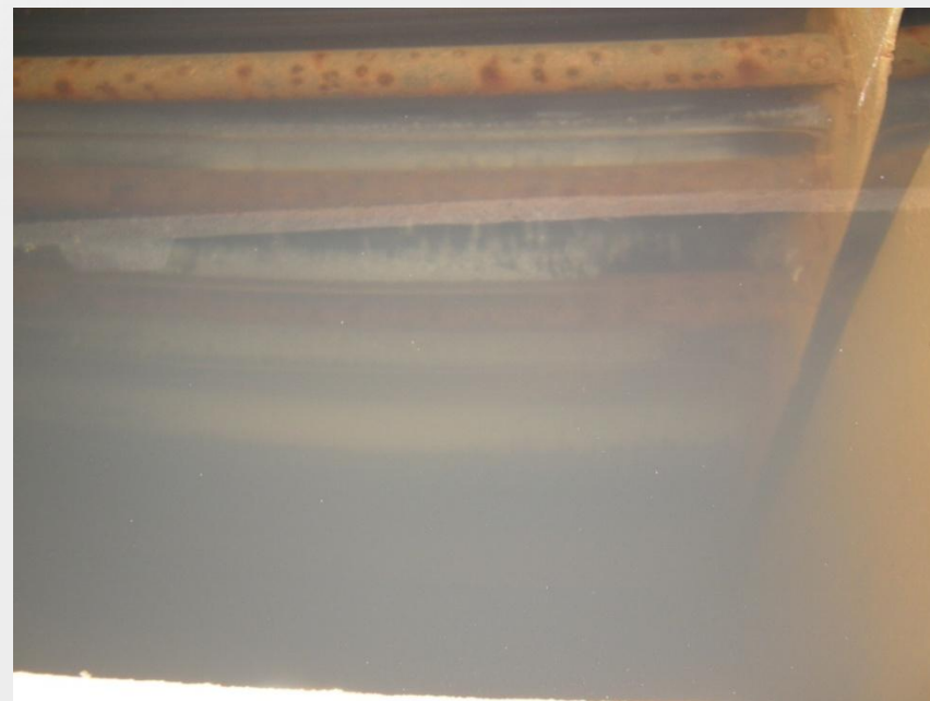
Przykład korozji i biokorozji w układzie wody lodowej
