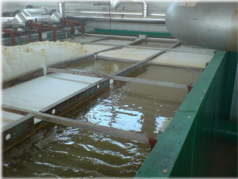
Fotografia wykonana podczas zabiegu dezynfekcji silnie skażonej wody. Na pianie widoczne fragmenty biofilmu
