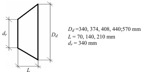
Fig. 2. Diffuser geometry
