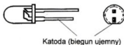
Rys. 5.22 Biegunowość diody LED
