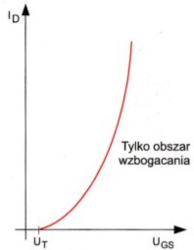
Rys. 4.23. Charakterystyka przejściowa tranzystora E-MOSFET typu N
