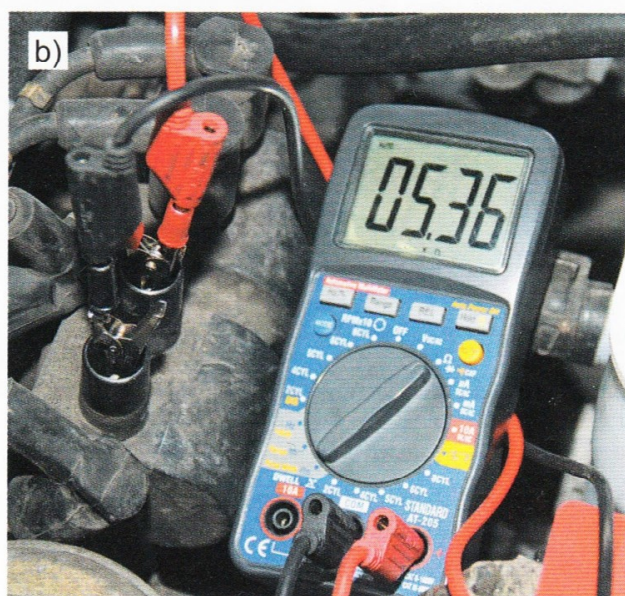
Rys. 7.5. Sposób pomiaru: a) napięcia zasilania cewki dwubiegunowej, b) rezystancji uzwojenia wtórnego cewki
