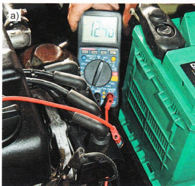
Rys. 7.5. Sposób pomiaru: a) napięcia zasilania cewki dwubiegunowej, b) rezystancji uzwojenia wtórnego cewki
