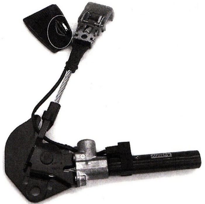
Rys. 10.44. Pirotechniczny napinacz pasów współpracujący z zapięciem pasów [18]
