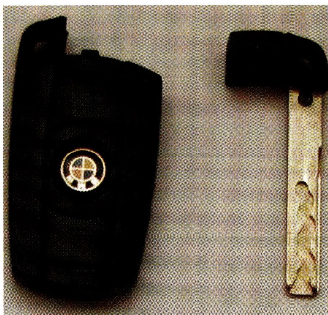
Rys. 10.70. Klucz elektroniczny z kluczem mechanicznym wyjętym z jego obudowy
