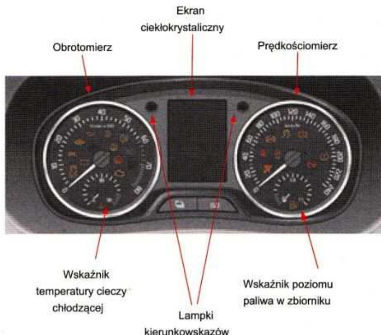
Rys. 5.2. Zestaw wskaźników pokładowych samochodu Škoda Fabia
