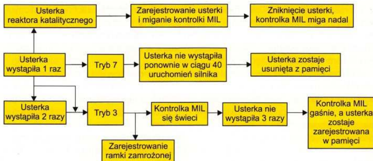
Rys. 8.2. Algorytm wykrywania usterek w trakcie procedur diagnostycznych [42]
