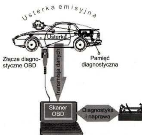
Rys. 8.3. Sposób diagnozowania pojazdu za pomocą skanera OBD [42]
