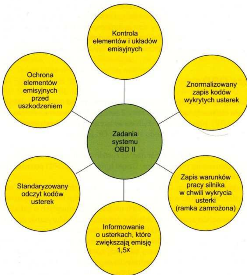
Rys. 8.1. Zadania systemu OBD II [42]
