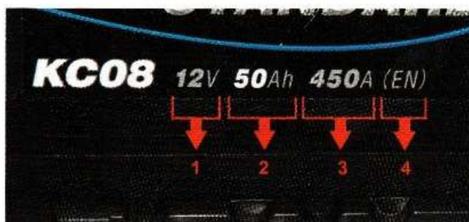
Rys. 4.4. Podstawowe informacje umieszczane na tabliczce znamionowej akumulatora:
