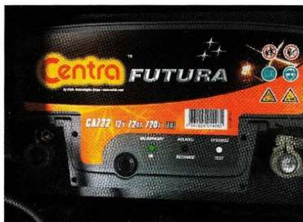
Rys. 4.8. Wskaźnik naładowania bezobsługowego akumulatora pojazdu (tzw. magiczne oczko)
