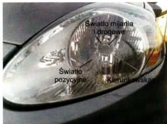
Rys. 4.3. Jeden reflektor dla światła drogowego oraz dla światła mijania
