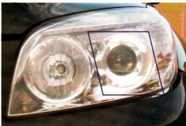
Rys. 4.8. Lewe światło przednie z projekcyjnym światłem mijania (ramka niebieska)
