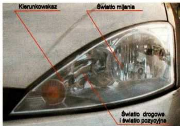
Rys. 4.4. Światło mijania oraz światło drogowe mają odrębne reflektory
