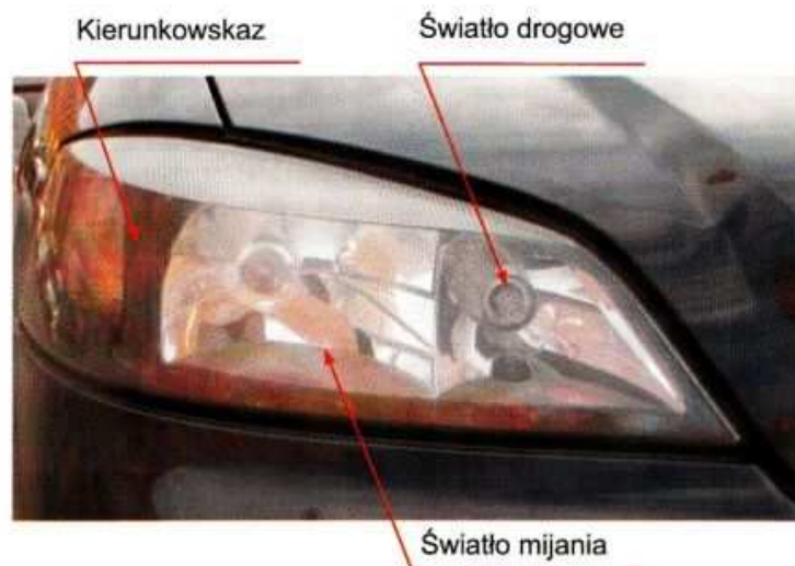
Rys. 4.10. Reflektor przedni całopowierzchniowy z odbłyśnikami typu FF
