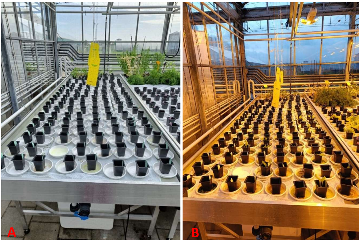
Rysunek 6 Stanowisko badawcze eksperymentów wazonowych z wykorzystaniem naturalnego (A) i sztucznego (B) oświetlenia uprawy.
