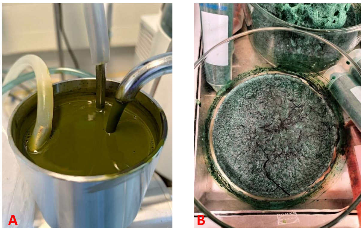
Rysunek 10 Zbiornik magazynowo-zwrotny biomasy poddawanej dezintegracji (A) i biomasa po liofilizacji gotowa do zastosowania w procesach nawożenia (B).
