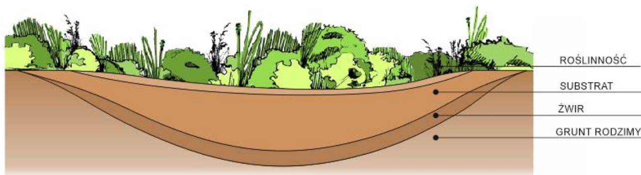
Rysunek 2. Schemat układu warstw w ogrodzie deszczowym. Źródło: opracowanie własne.
