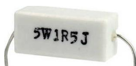
Rysunek 2. Przykładowy rezystor opisany liczbowo.
