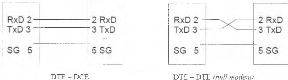
Rys. 4.2. Łączenie styków przy komunikacji portem szeregowym 9-cio pinowym.
