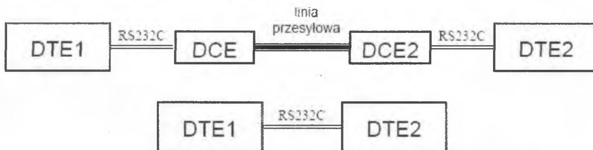
Rys. 4.1. Umiejscowienie RS232 w torze transmisyjnym.
