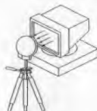
Rys. 7.5.4. Przykład ustawienia sondy przy pomiarze natężenia pola elektrycznego monitora
