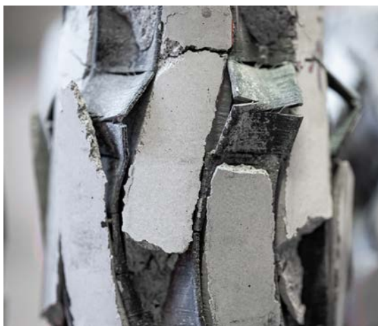
Próbki betonowe zbrojone przestrzennymi elementami plastikowymi, wykonanymi za pomocą druku 3D (geometria gyroidów)
